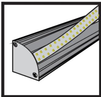
6. Localice la cubierta de acrílico y colóquela sobre el perfil, después haga presión sobre la tapa para que ensamble correctamente.
